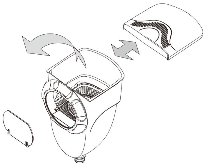
2. Dévissez le collier de skimmer intérieur. Assurez vous que le joint d'étanchéité extérieur du skimmer soit correctement positionné.
