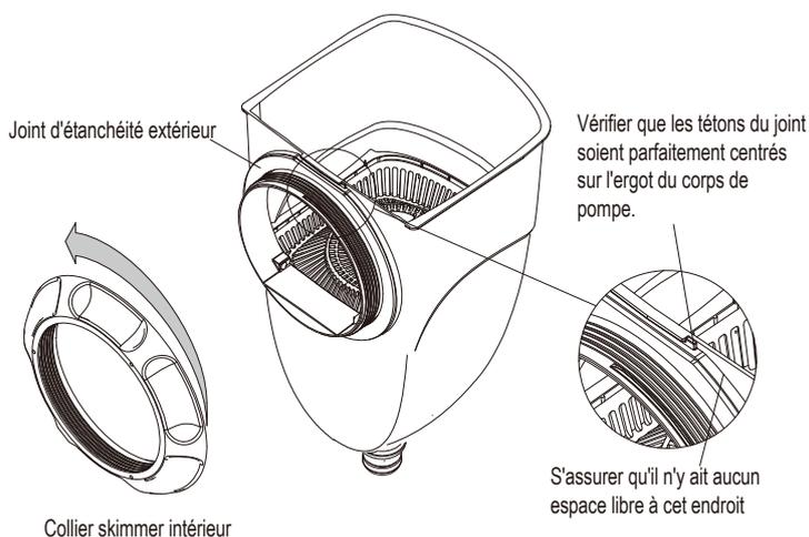
3. Insérez la partie circulaire filetée du skimmer à travers le trou du liner. Puis visser fermement le collier intérieur.
