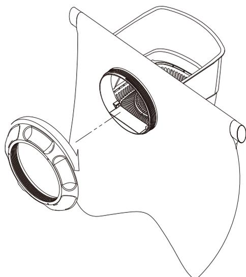
4. Installez le clapet sur le corps de pompe en assurant que la mousse soit positionnée sur la face du clapet dirigé vers le corps de pompe.
